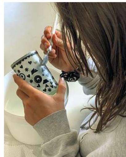
In Feinarbeit werden Klebemotive auf das Glas appliziert und nach dem Sandstrahlen wieder entfernt.
